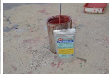
船底塗料4kg缶に対して 本製品1袋(120g)を使用します。
