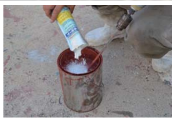
本製品を切取線より開封して 船底塗料に混ぜます。
